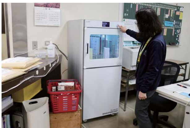
図書館に設置された図書除菌機
