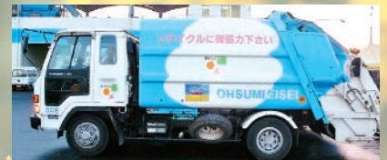
▲家庭から出された廃食油を精製した軽油代替燃料で走るゴミ収集車
