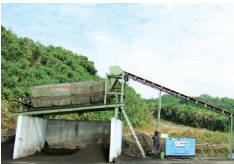
▲トランベルといわれる、ふるい機を使い、不純物を取り除きます。
