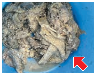
郵便局前MP場1号ポンプ他の故障(不織布、ネジ) ↑ →
